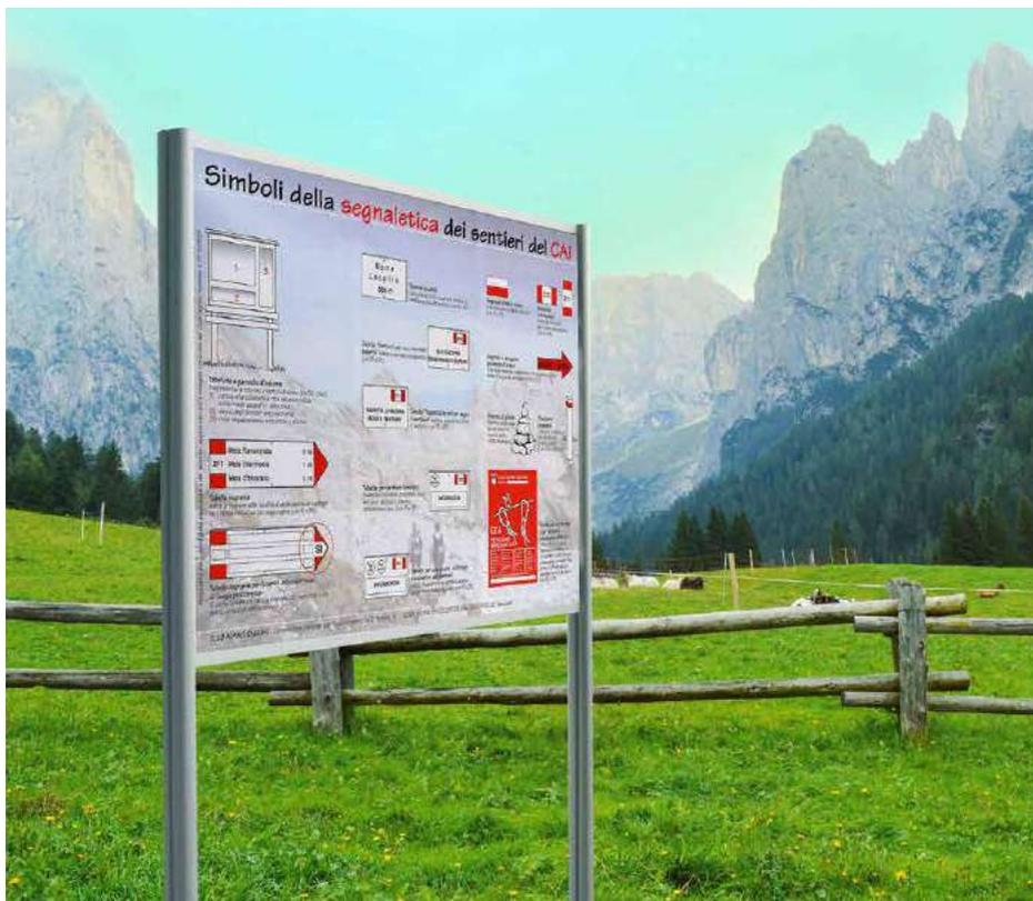
Pannello informativo per esterni, mono o bifacciale. Montanti in alluminio anodizzato silver con tappi di chiusura superiore e basi predisposte per il fissaggio a terra da 250x250 mm. Traverse orizzontali in alluminio. Fondo in lamiera preverniciata bianca 10/10 da ambo i lati con interno in forex da 5 mm. Altezza massima 2000 mm.
