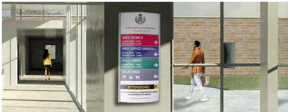
Targa a parete di grande formato linea GENIUS composta da profili laterali in alluminio e pannello di fondo convesso in forex bianco. Terminali in metallo verniciato a polveri silver e protezione in PVC antiriflesso per la gestione di grafiche intercambiabili. Fissaggio a parete con viti e tasselli. Possibilità di intercambiare singole sezioni di grafica inserendo il divisorio TDIV.
