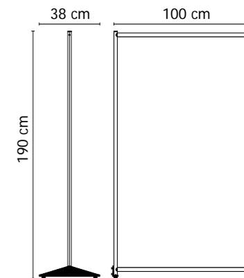
Pannello divisorio autoportante singolo composto da struttura in alluminio anodizzato silver e piedini fissi in metallo verniciati a polveri. Superficie in forex bianco o plexi trasparente. Disponibile su richiesta kit ruote con sistema frenante.
