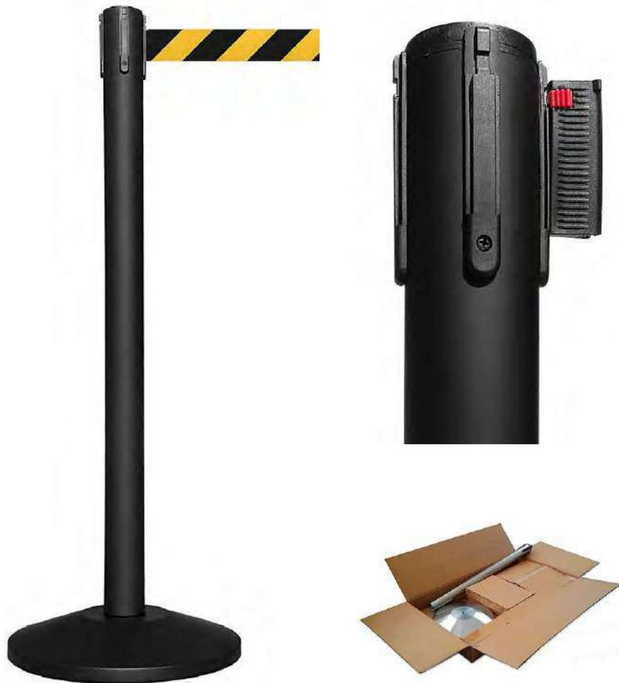
Colonnina con montante e base in metallo finitura nero opaco. Anello antiruggine in ABS nero. Tappo superiore con 3 clip riceventi e uscita del nastro. Lunghezza nastro 3 mt con clip di sicurezza, personalizzabile da entrambi i lati con logo ad 1 o più colori. Dotato di sistema tendinastro autofrenante. Altezza 101 cm. Peso totale kg 10.
