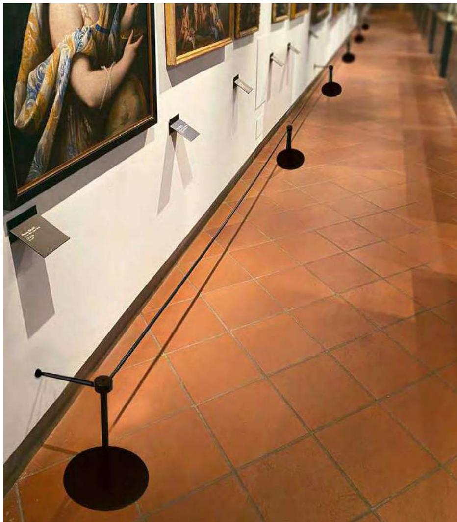
Meccanismo di distanziamento adattabile alle colonnine linea museum. Tappo superiore di concatenazione in PVC nero con quattro fori che consente il posizionamento della barra in diverse direzioni. Barra diametro 13 mm in metallo verniciato nero, lunghezza 2 metri con sistema di aggancio tramite brugola. Attacco a muro ricevente per barra in PVC nero. Modulabile a seconda delle esigenze.
