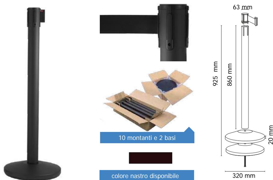
Colonnina con montante e base in metallo finitura nero opaco. Anello antiruggine in ABS nero. Tappo superiore con 3 clip riceventi e uscita del nastro. Lunghezza nastro 2,5 mt con clip di sicurezza, personalizzabile da entrambi i lati con logo ad 1 o più colori. Dotato di sistema tendinastro autofrenante. Altezza 92,5 cm. Peso totale kg 8,3.
